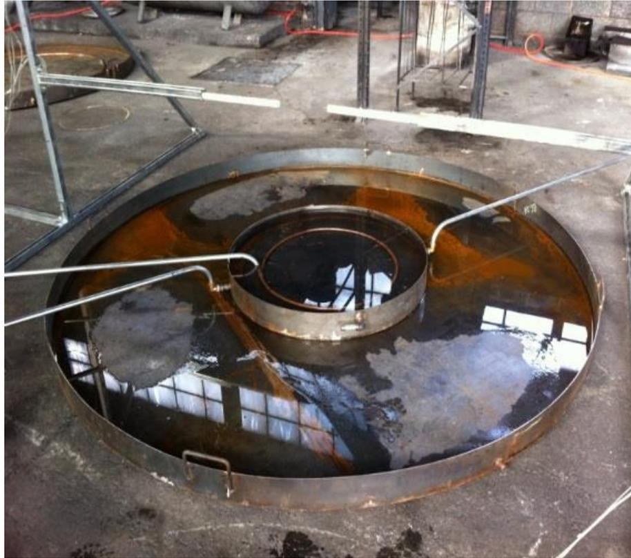
**Figura 3.3** Cubeta de ensayo de 2 m, donde se puede observar el sistema de alimentación de combustible (del Deliverable 15<sup>[13]</sup> de LOCAFI)
