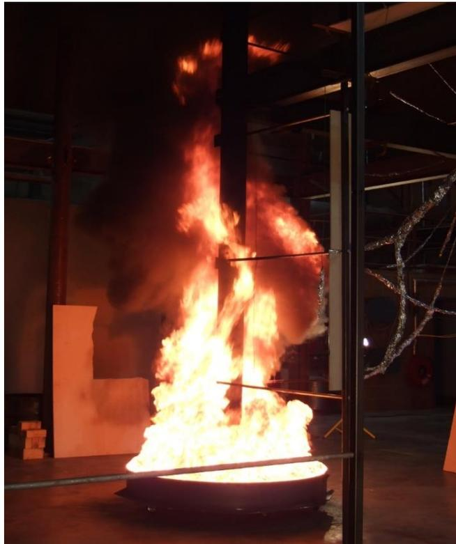
**Figura 3.1** Ensayo de laboratorio de una columna expuesta a un fuego localizado
