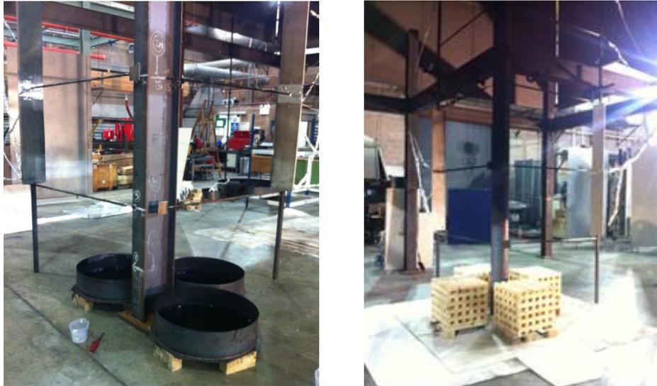
**Figura 3.4 Montaje del ensayo para fuego localizado en FireSERT (izquierda: cubetas para contener combustible líquido, derecha: pallets de madera)**
