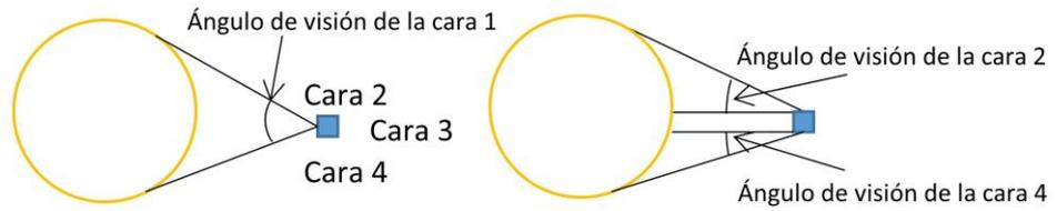
**Figura A.7 Ejemplo de interacción cilindro – columna (vista superior)**
