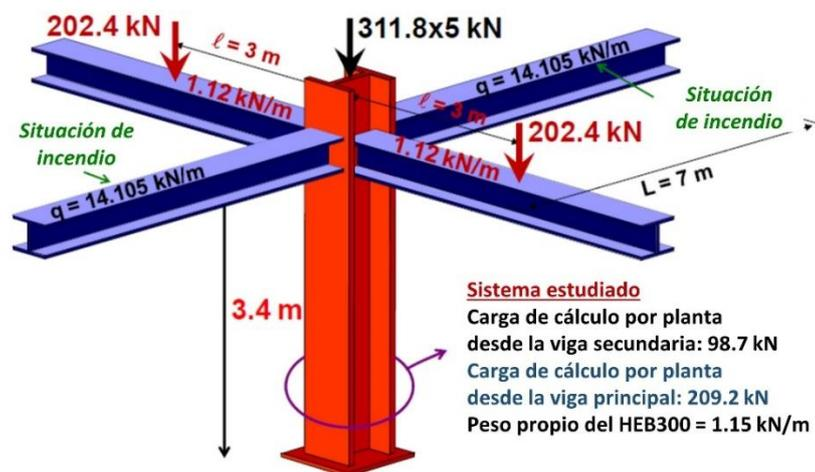
Figura D.13 Cargas aplicadas sobre la columna de planta baja
