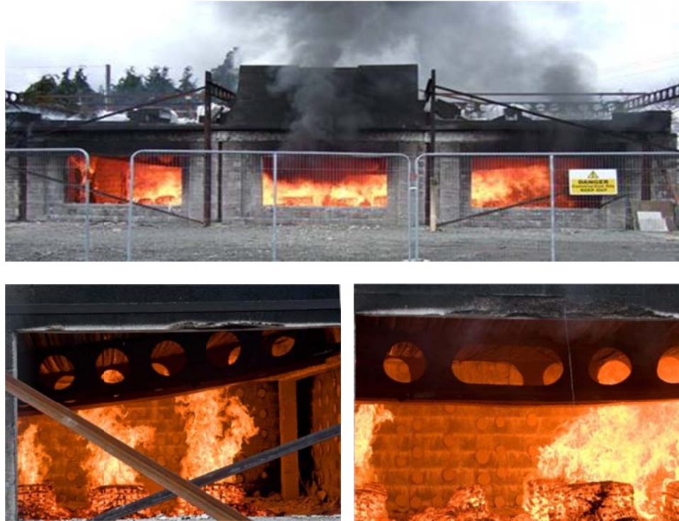
Figure 7.52 Feu développé dans le compartiment
