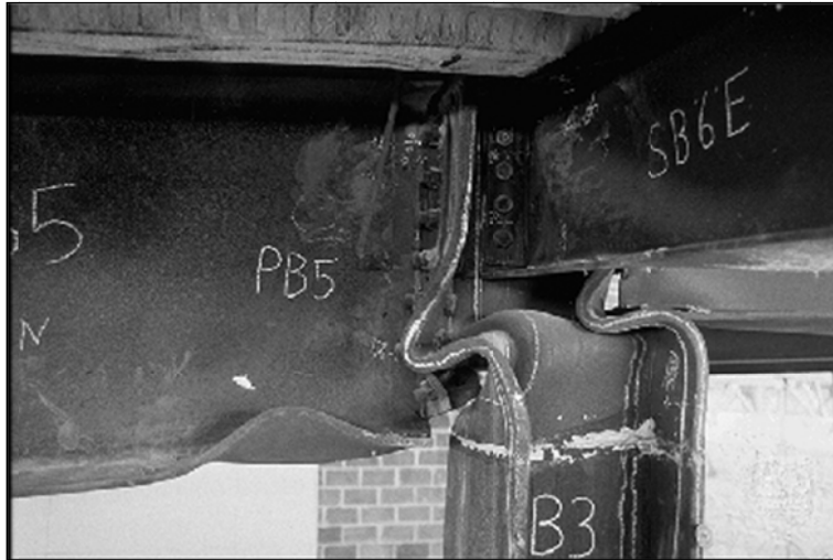
Figure 2.7 Tête de colonne écrasée après le test
