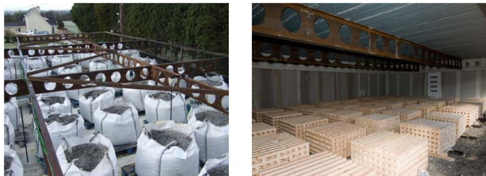
Figure 7.49 (a) Charge statique verticale, (b) Chevrons en bois utilisés pour la charge au feu
