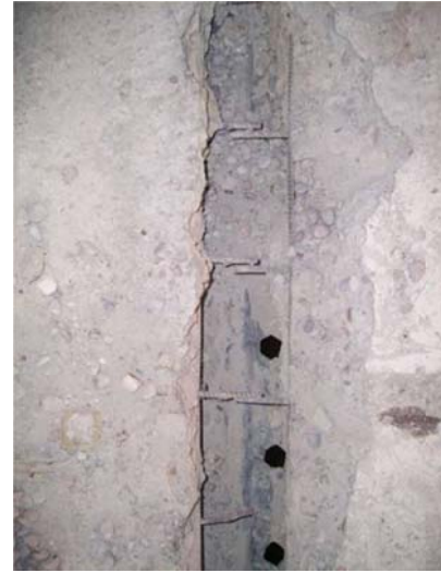
(a) Assemblage des armatures soudées avant le coulage du béton (b) Etat de l'assemblage d'armatures à la position de la fissure après refroidissement
