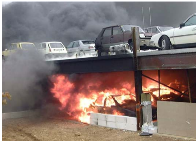
Figure 3.3 Développement complet du feu pendant un essai
