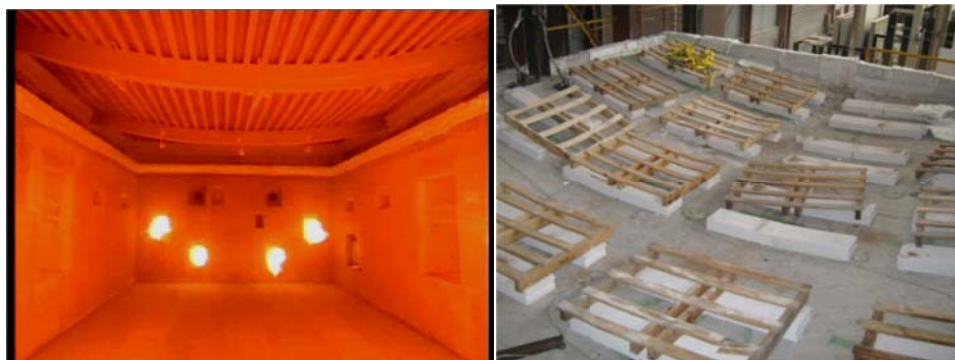
Figure 7.38 Plancher testé pendant et après le feu
