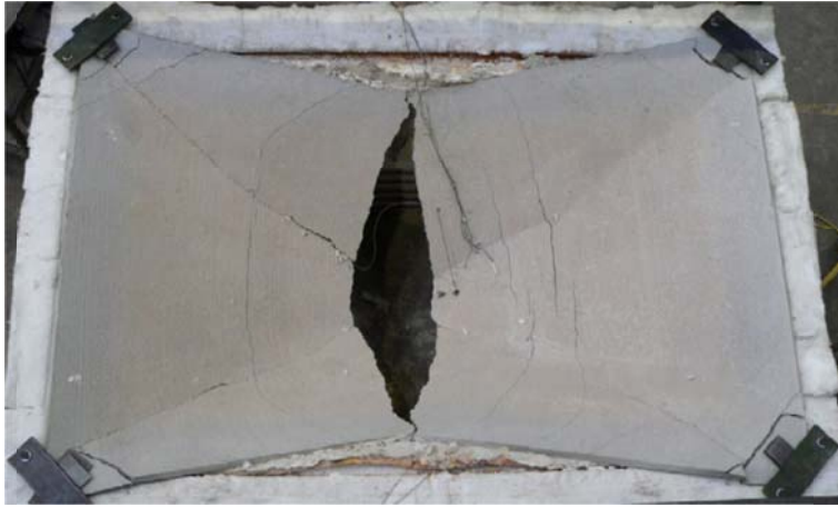
Figure 4.6 Mode de rupture des dalles d'essai à températures élevées
