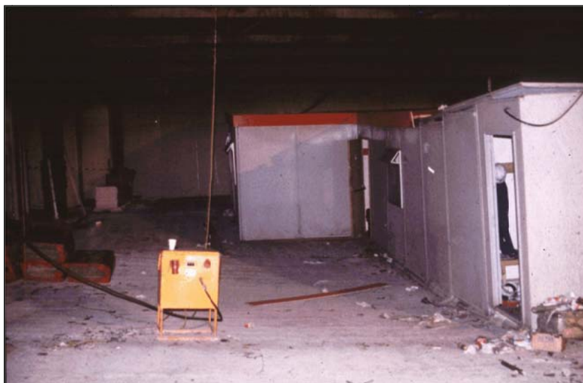
Figure 4.2 Vue du plancher déformé au dessus du feu (la flèche maximale était d'environ 600 mm)
