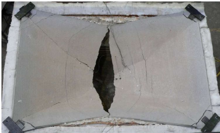
Figuur 4.6 Bezwijkvorm voor testplaten bij hoge temperaturen
