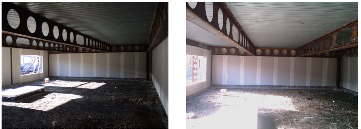
Figuur 7.44 : Testcompartiment met lange onbeschermde liggers met ronde gaten
