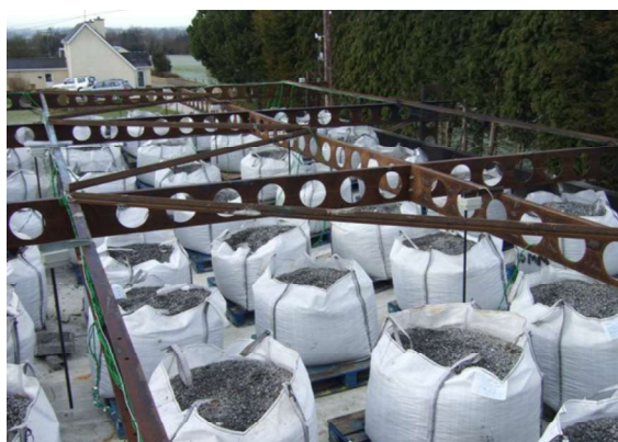
Figuur 7.49 : (a) Verticale statische belasting , (b) Houten kribben gebruikt voor de vuurbelasting
