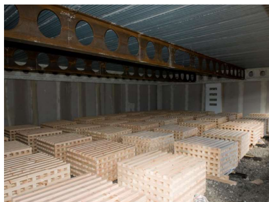
Figuur 7.49 : (a) Verticale statische belasting , (b) Houten kribben gebruikt voor de vuurbelasting
