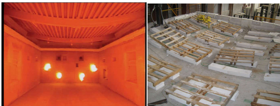
Figuur 7.38 Geteste vloer gedurende en na de brand
