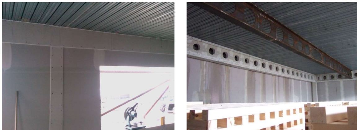
Figuur 7.47 : Bescherming door een keramische deken en een gipsbeplating aan de binnenzijde van het compartiment
