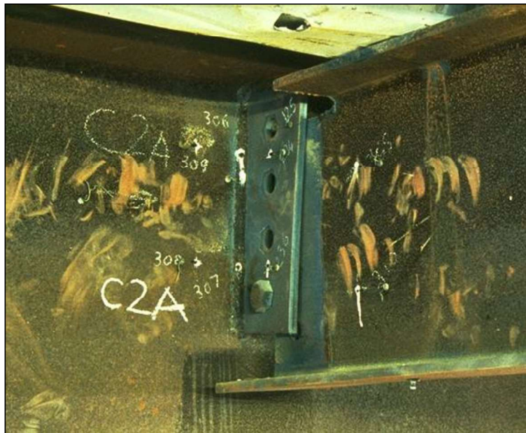
Figuur 2.8 Lipverbinding na de test
