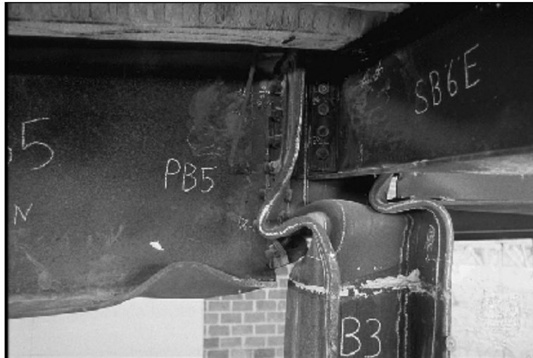
Figuur 2.7 In elkaar gedrukte kolomkop na de test
