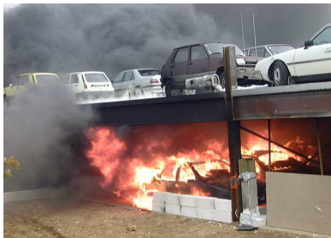
Σχήμα 3.3 Πλήρης ανάπτυξη της πυρκαγιάς κατά τη διάρκεια πειράματος
