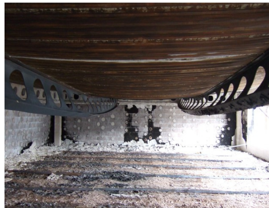
Σχήμα 7.53 : Μετατόπιση της πλάκας και της μη μονωμένης δοκού μετά από την πυρκαγιά.
