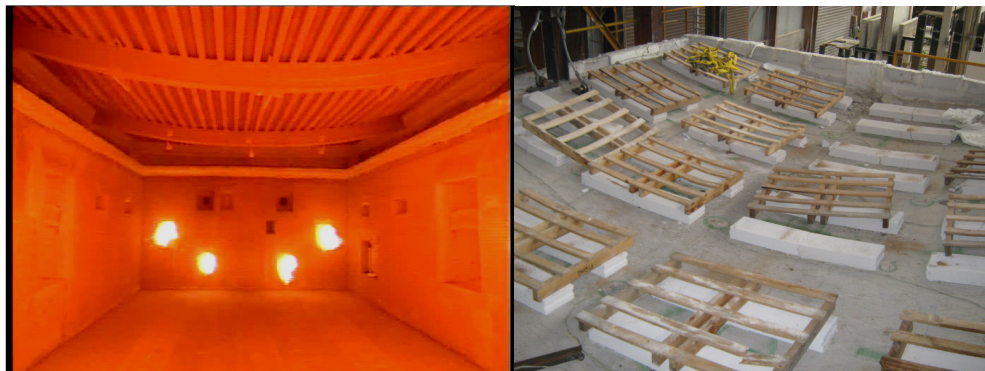
Σχήμα 7.38 Η πλάκα του πειράματος πριν και μετά από την πυρκαγιά
