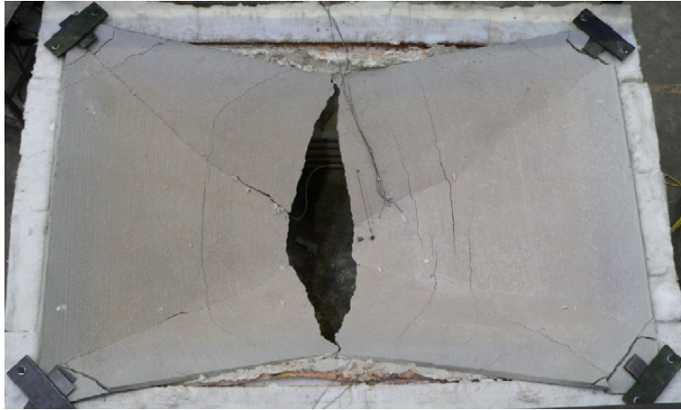
Σχήμα 4.6 Τρόπος αστοχίας των πλακών σε πειράματα με υψηλές θερμοκρασίες
