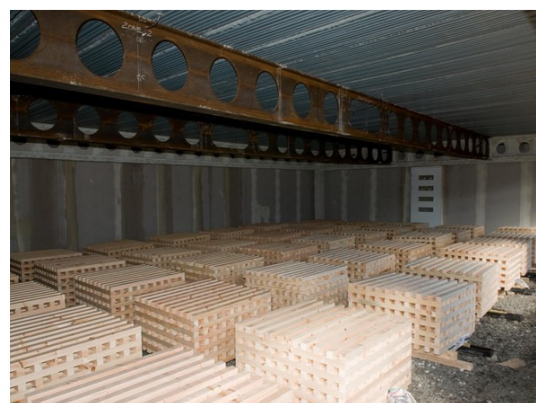
Σχήμα 7.49 : (α)Κατακόρυφο στατικό φορτίο (β)Ξύλινα σανίδια ως πυροθερμικό φορτίο
