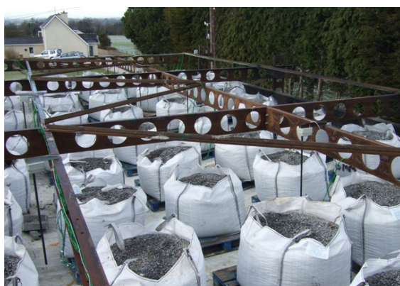
Σχήμα 7.49 : (α)Κατακόρυφο στατικό φορτίο (β)Ξύλινα σανίδια ως πυροθερμικό φορτίο
