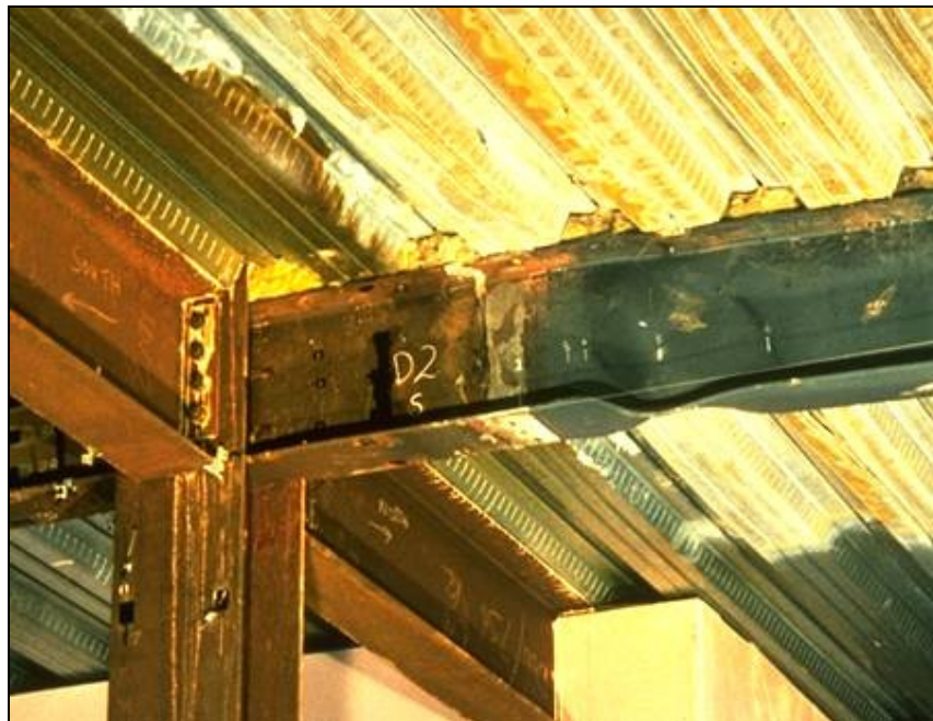
Σχήμα 2.5 Λυγισμός του πέλματος στη δεσμευμένη δοκό
