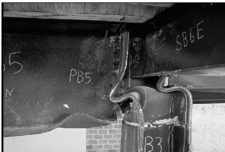
Σχήμα 2.7 Συνθλιμμένη κεφαλή σύλου μετά από το πείραμα
