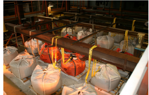
Σχήμα 7.24 Συνθήκες φορτίου σύμμικτης πλάκας χάλυβα-σκυροδέματος εκτεθειμένης σε πυρκαγιά
